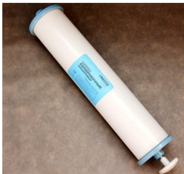
Рис. 6. Калибровочный шприц для поверки спирометра СМП-21/01 – “Р-Д”, 3 л
