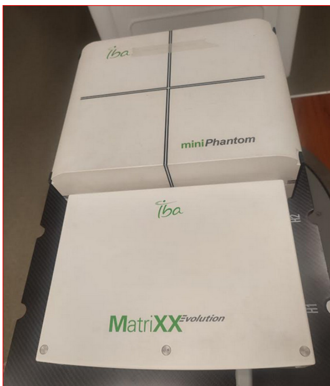
Рис. 3. Измерительная дозиметрическая система: матрица MatriXX™, помещенная в фантом MiniPhantom
