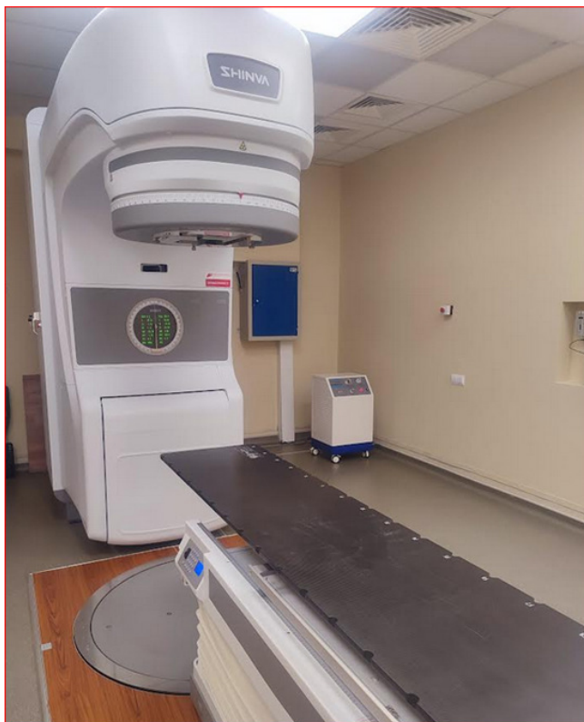
Рис. 2. Линейный ускоритель электронов ХН600Е SHINVA с энергией 6 МэВ
